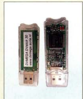
DV-Stick mit integriertem AMBE 3000: der DV Mega DV30
