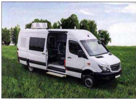
Wellenfänger: Kaum von einem Campingfahrzeug unterscheidet sich dieser Peilwagen mit der Aktiv-Peilantenne DFA2440 für 20 MHz bis 3 GHz auf dem Dach.
