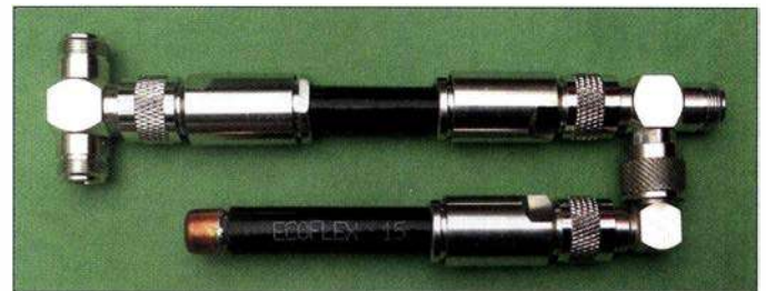
Bild 15: Fertiger Stichleitungs-Transformator für das 2-m-Band Screenshots und Foto: DH2MIC
