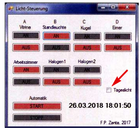
Bild 13: Momentaufnahme der Oberfläche der Steuersoftware; nur die Standleuchte und die Lampe am Arbeitsplatz sind eingeschaltet. Am fehlenden Haken im weißen Kästchen ist zu erkennen, dass kein Tageslicht vorhanden ist.
