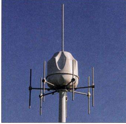
Rundblick: 21 Antennenelemente peilen Sender von 500 kHz bis 3 GHz auf besser als 1,5° genau. 55 kg wiegt dieser Mobilpeiler.
