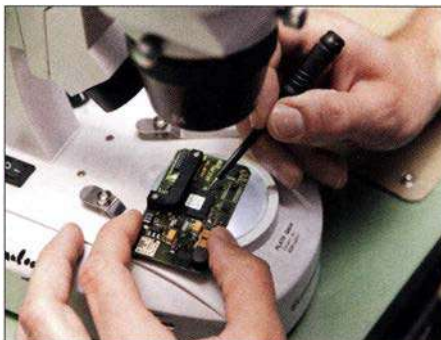
Scharfer Blick: Manche Bauteile lassen sich in der Entwicklung nur unter dem Mikroskop einlöten und vermessen.
