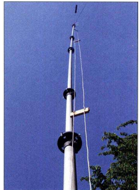
Bild 2: Strahlungsgekoppelte Zweiband-L-Antenne von DK6ED, hier an einem stabilen GFK-Mast und mit einer Zweidrahtleitung, die die vertikalen Abschnitte der beiden „L“ bildet Foto: DK6ED
